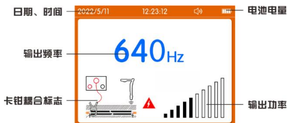
图 5-13 管线探测模式卡钳耦合输出界面
