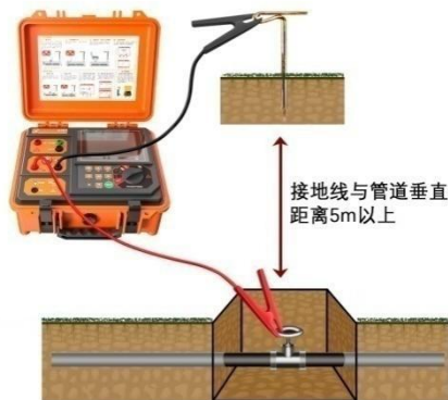
图 5-3 金属管道直连接线图
