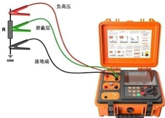
图 8-8 绝缘电阻测量接线（带屏蔽）
