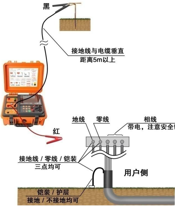
图 5- 21 运行电缆零线 / 地线 / 护层注入法
