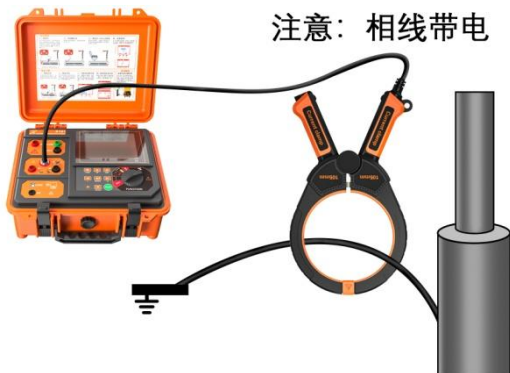
图 5-18 运行电缆卡钳耦合法 2（卡电缆接地线）
