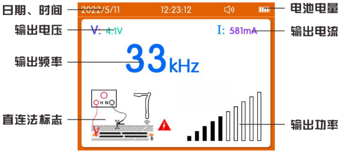
图 5-1 管线探测模式直连法输出界面图
