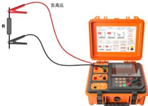
图 8-7 绝缘电阻测量接线（无屏蔽）
