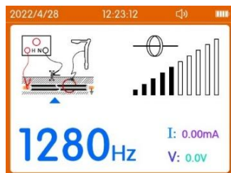
图 4-10 电缆识别信号发射界面
