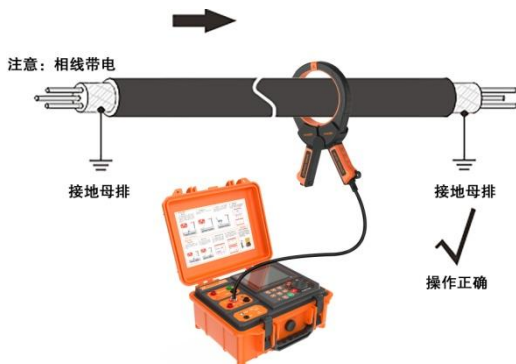
图 5-16 运行电缆卡钳耦合合法 1（卡电缆本体）
