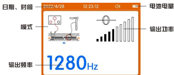
图 5-14 电缆识别模式卡钳耦合输出界面
